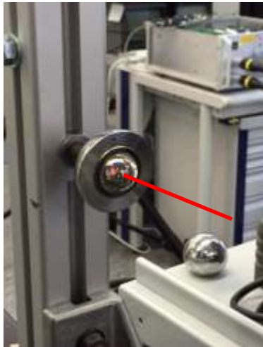
1.5" SCE -Reflector well oriented
